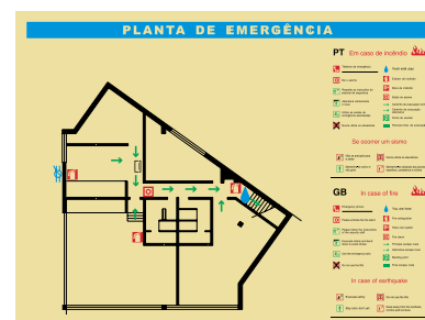
Fig. 1 - Exemplo de uma Planta de Emergência
